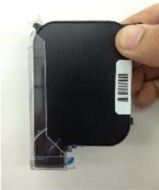
3. Nach dem Schütteln der Kartusche nehmen Sie den Cartclip ab und wischen Sie die Düsenplatte mit einem fusselfreien trockenen Tuch ab. Die Düsenplatte sollte nach unten zeigen.
