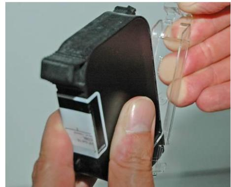
Abb. 1: Einsetzen einer HP-Kartusche in den CartClip
