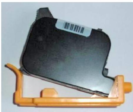
Abb. 44: Einsetzen der Tintenkartusche in den Ink-Aktivator
